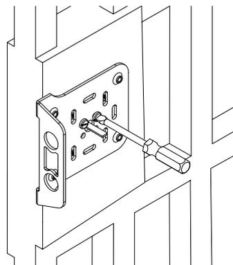
6. Ajustar la placa de fijación con los pernos al portacilindro exterior.
