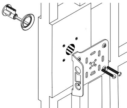
5. Colocar la placa de fijación, el portacilindro exterior y el aro. Luego fijarlos con los pernos.
