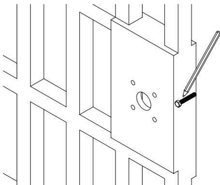
4. Cortar los stovebolts del portacilindro exterior a 0.5 cm menos del espesor de la puerta. Por ejemplo, si la puerta mide 4 cm de ancho, cortar los stovebolts a 3.5 cm.
