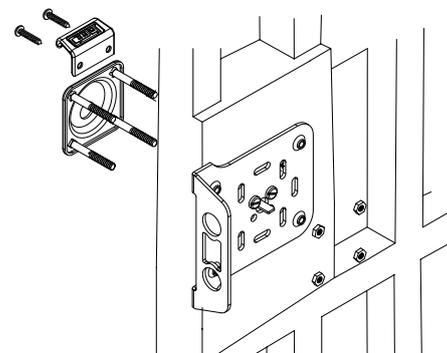
9. Fijar el planchón mediante sus 4 pernos y tuercas. Fijar también el jalador exterior con sus respectivos tornillos.
