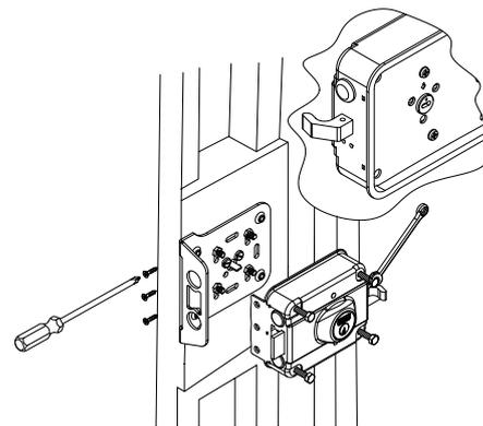
12. Colocar la caja de la cerradura por el lado interior de la puerta y fijarla con sus tornillos. **NOTA:** Para su correcto funcionamiento es importante que la lengüeta se coloque dentro del buje en la posición correcta (con el punto apuntando a la flecha de la tapa).
