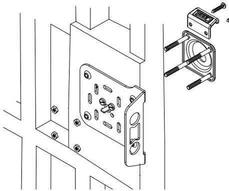
9. Fijar el planchón mediante sus 4 pernos y tuercas. Fijar también el jalador exterior con sus respectivos tornillos.
