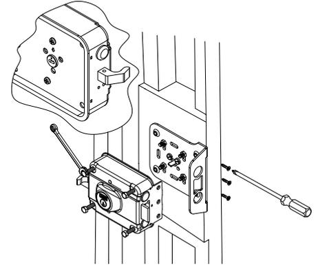
12. Colocar la caja de la cerradura por el lado interior de la puerta y fijarla con sus tornillos. **NOTA:** Para su correcto funcionamiento es importante que la lengüeta se coloque dentro del buje en la posición correcta (con el punto apuntando a la flecha de la tapa).
