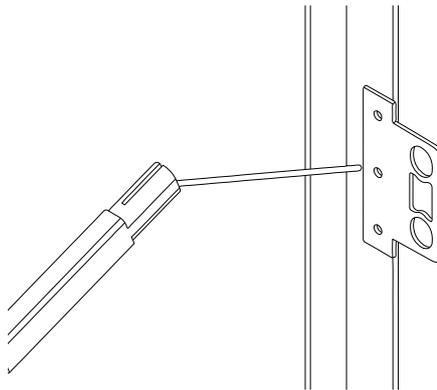
14. Colocar los puntos de soldadura para fijar el contrafrente al marco de la reja o puerta de metal.
