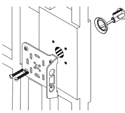
5. Colocar la placa de fijación, el portacilindro exterior y el aro. Luego fijarlos con los pernos.
