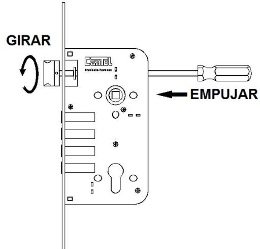
2. Presionar el picaporte hasta que esté fuera del frontis y girar. Retirar el destornillador suavemente y comprobar que el picaporte esté en la posición deseada.
